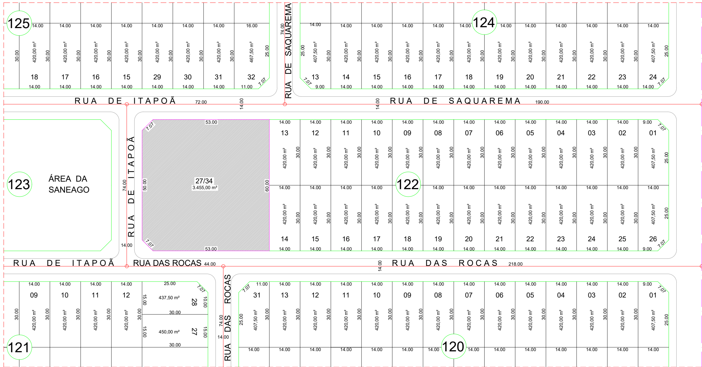
PLANTA DE SITUAÇÃO APÓS REMEMBRAMENTO- ESC. 1:1000.
