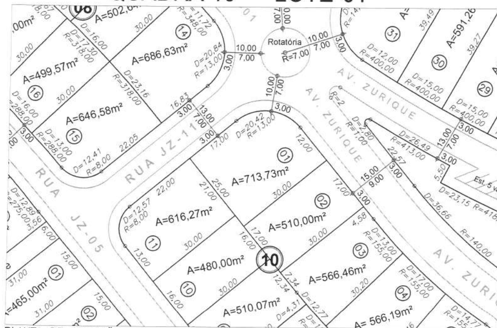
PLANTA DE SITUAÇÃO Escala 1:1.000
