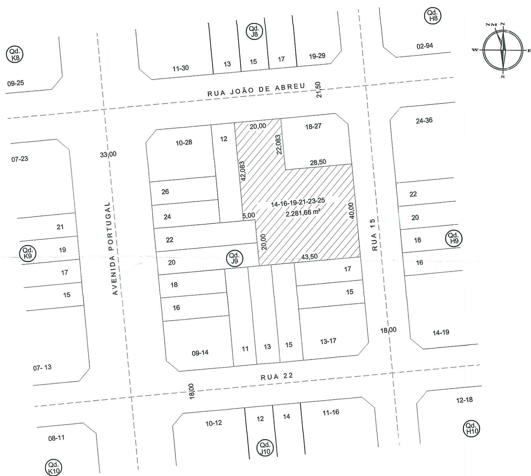
03 PLANTA DE SITUAÇÃO APÓS REMEMBRAMENTO ESCALA 1:1.000
