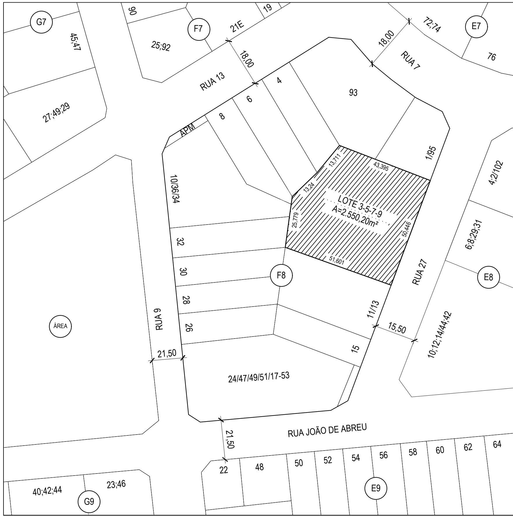
3 PLANTA DE SITUAÇÃO APÓS REMEMBRAMENTO ESCALA 1:1000
