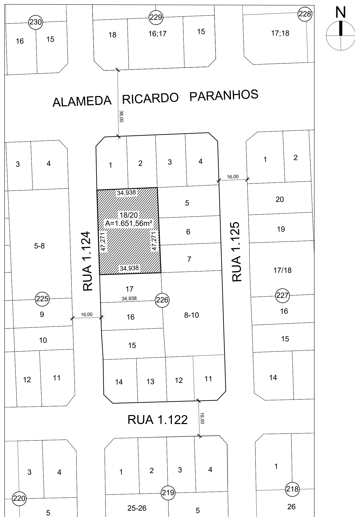
3 PLANTA DE SITUAÇÃO APÓS REMEMBRAMENTO ESCALA 1:1000
