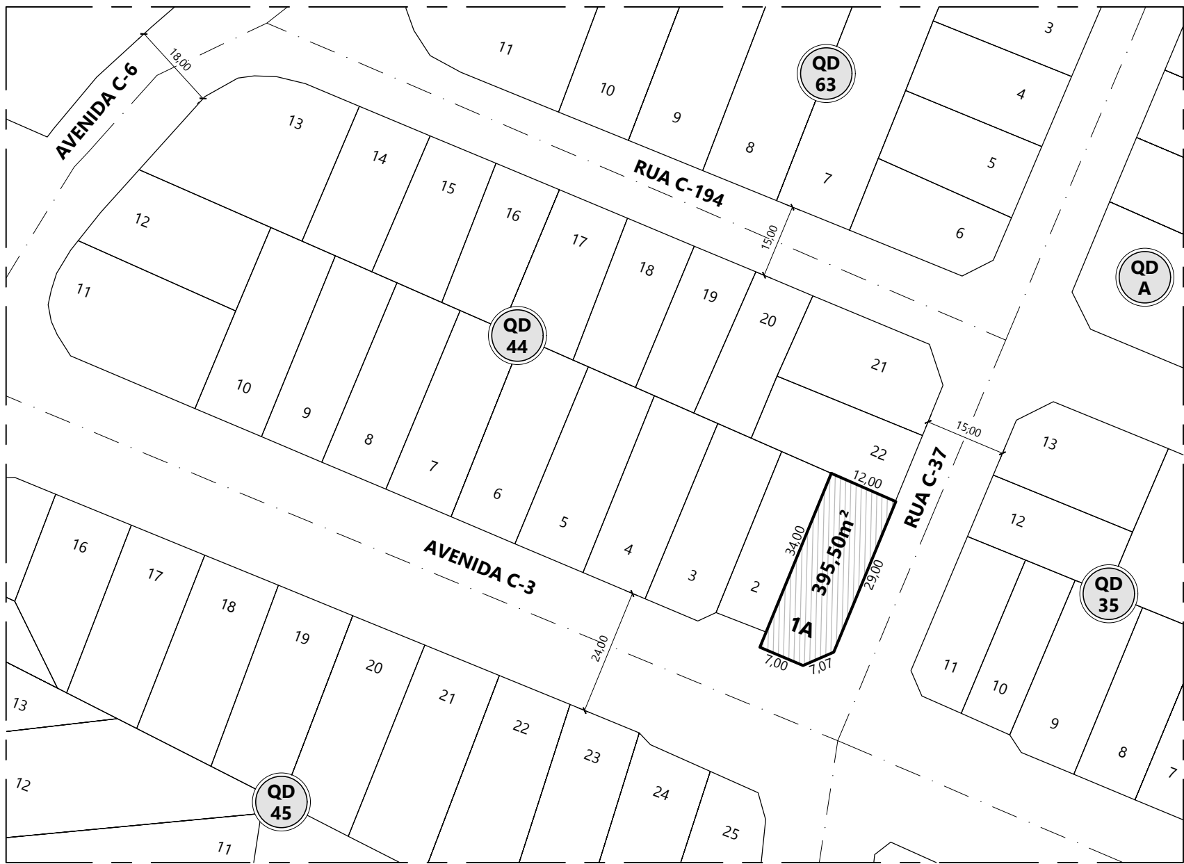
PLANTA DE SITUAÇÃO APÓS REMEMBRAMENTO ESCALA 1:1.000
