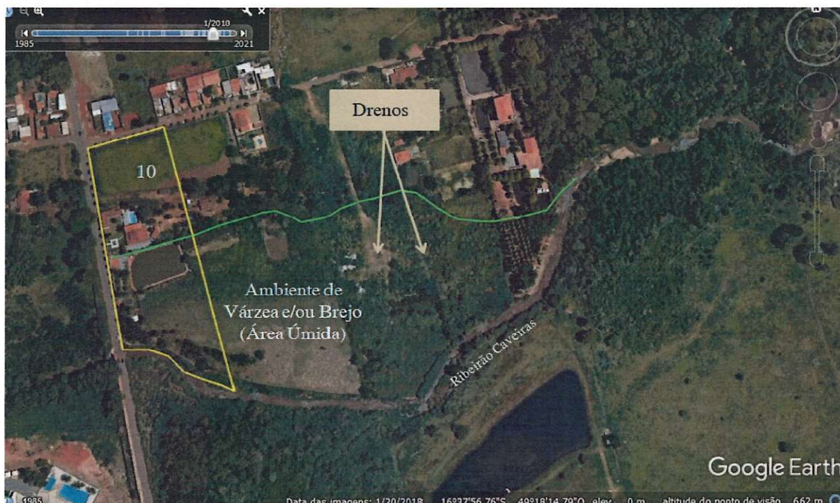
Figura 5: Área ao longo do Ribeirão Caveiras formada por ambiente úmido integrante de sua planície de inundação. Nota-se a instalação de dreno para escoamento das águas oriundas do lençol raso e aflorante.
