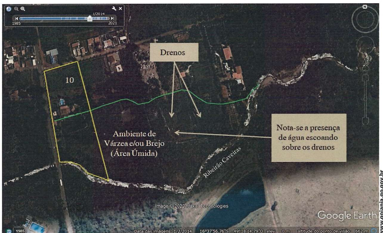
Figura 4: Área ao longo do Ribeirão Caveiras formada por ambiente úmido integrante de sua planície de inundação. Nota-se a instalação de dreno para escoamento das águas oriundas do lençol raso e aflorante.
