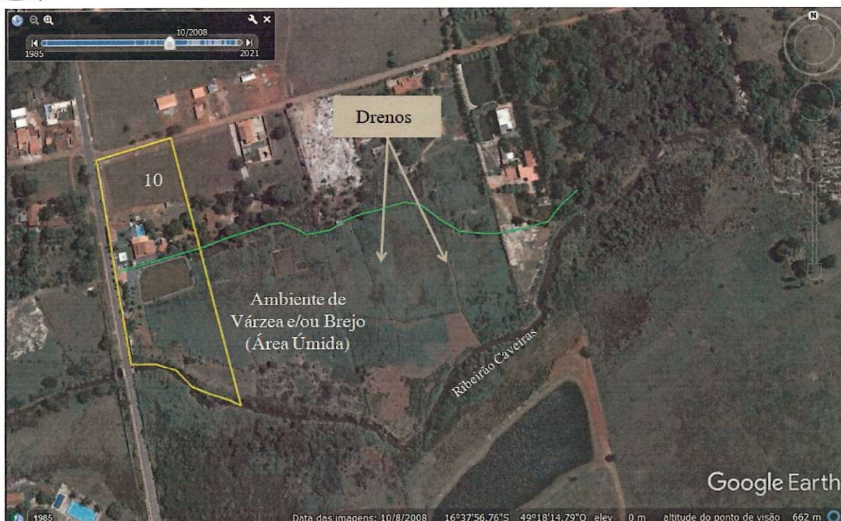
Figura 3: Área ao longo do Ribeirão Caveiras formada por ambiente úmido integrante de sua planície de inundação. Nota-se a instalação de dreno para escoamento das águas oriundas do lençol raso e aflorante.
