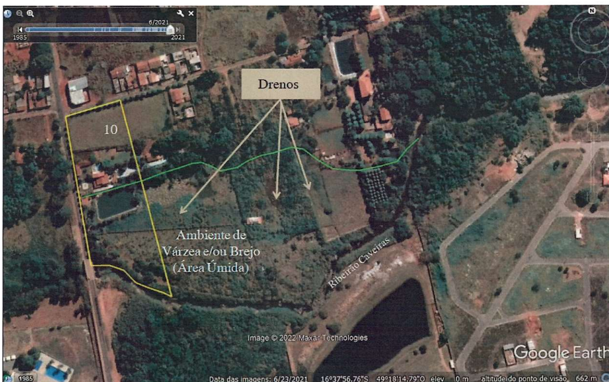
Figura 6: Área ao longo do Ribeirão Caveiras formada por ambiente úmido integrante de sua planície de inundação. Nota-se a instalação de dreno para escoamento das águas oriundas do lençol raso e aflorante.
