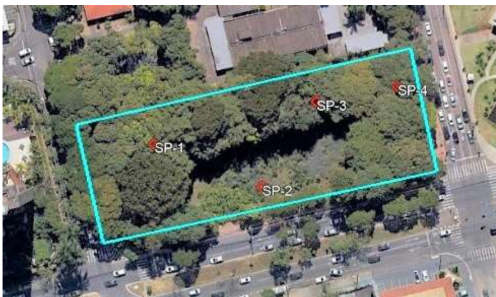
Figura 5 - Localização das sondagens SPT no terreno. Imagem Google Earth 11/05/2020.
