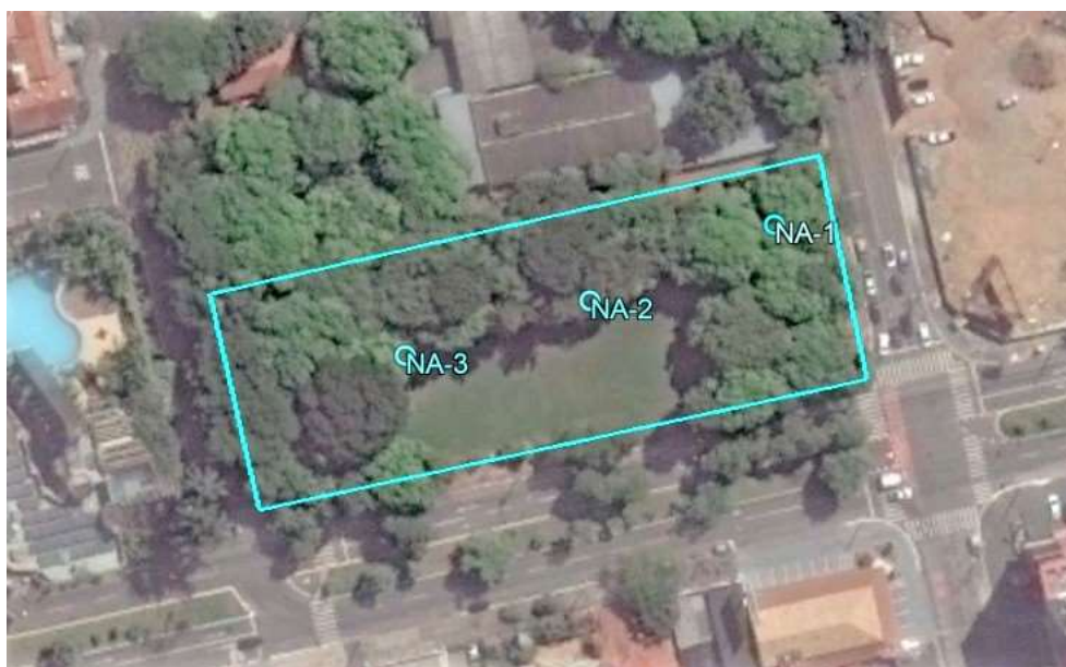
Figura 6 – Distribuição, no terreno, dos furos para medidas do nível d'água. (Imagem Google Earth 23/05/2016).
