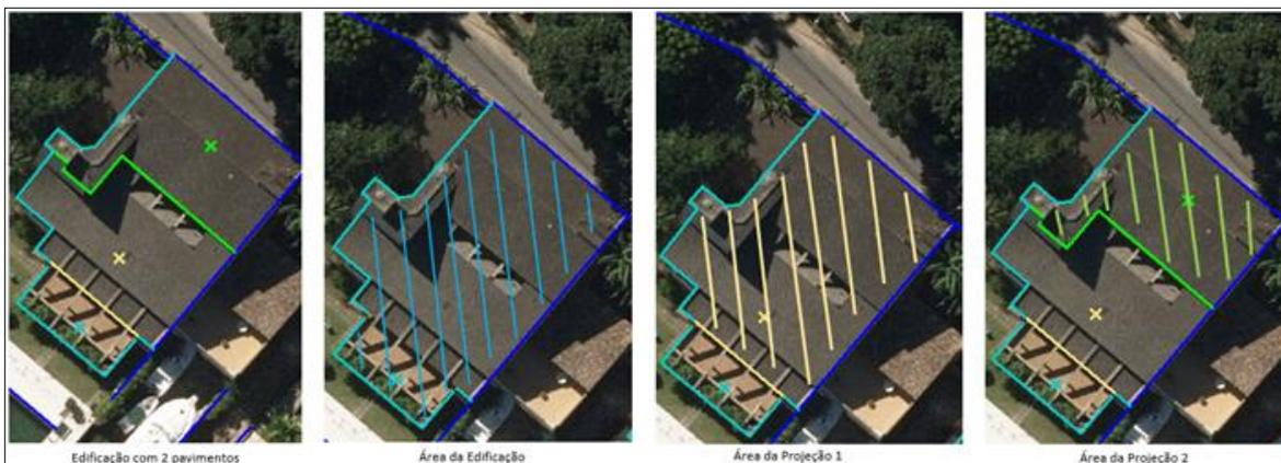
Figura 3 - Exemplo de restituição do tema Edificação.
