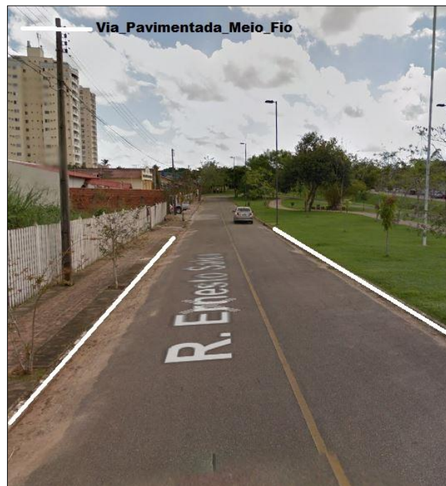
Figura 9 - Exemplo de restituição do tema Trecho de Arruamento Pavimentado com Meio Fio.
