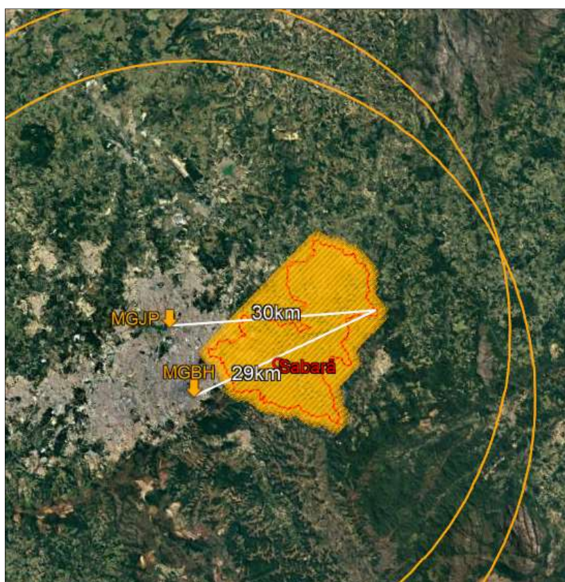
Figura 22 - Bases GNSS utilizadas no Mapeamento Móvel 360°, com raio de abrangência 30km.
