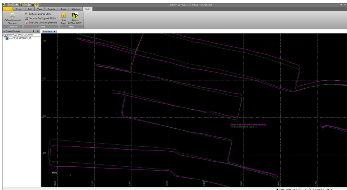
Figura 25 - Exemplo de trajetórias pós-processadas (verde) e trajetórias com coordenadas de navegação (magenta).
