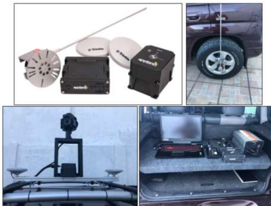
Figura 5 - Sistema GNSS/IMU LV220.
